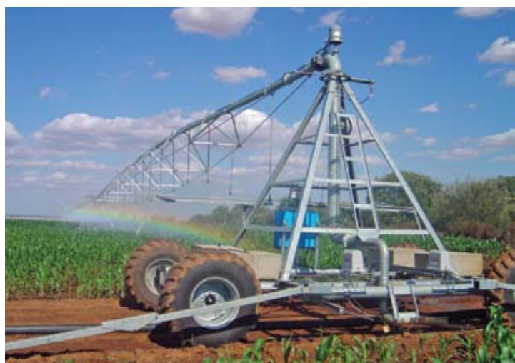
Двухколесная фронтальная дождевальная установка способна обрабатывать соседние поля за счет прохода сначала по одной стороне, последующего разворота на 180° и прохода в обратном направлении с обработкой другой стороны поля.
