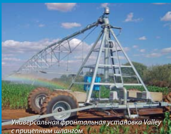
Дождевальная установка Valley Rainger с функцией разворота
